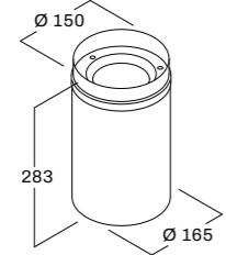
**Filtro carbone cilindrico**
